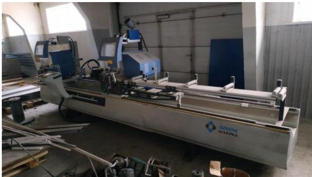
Рисунок 4 – Двухголовочная пила Wizzard/Ozgenic OMRM 113 4
